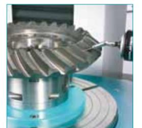
Измерение конических зубчатых колёс
